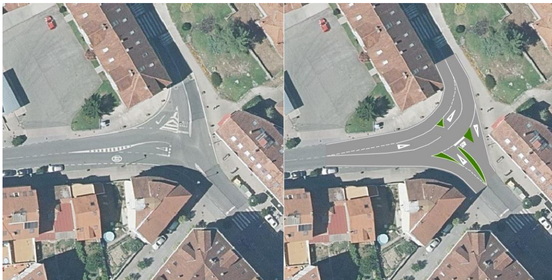
Remodelación de accesos no PECHA
